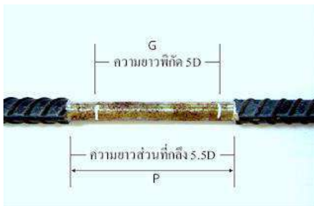
รูปที่ 3-20 ตัวอย่างเหล็กข้ออ้อยที่ผ่านการกลึง
