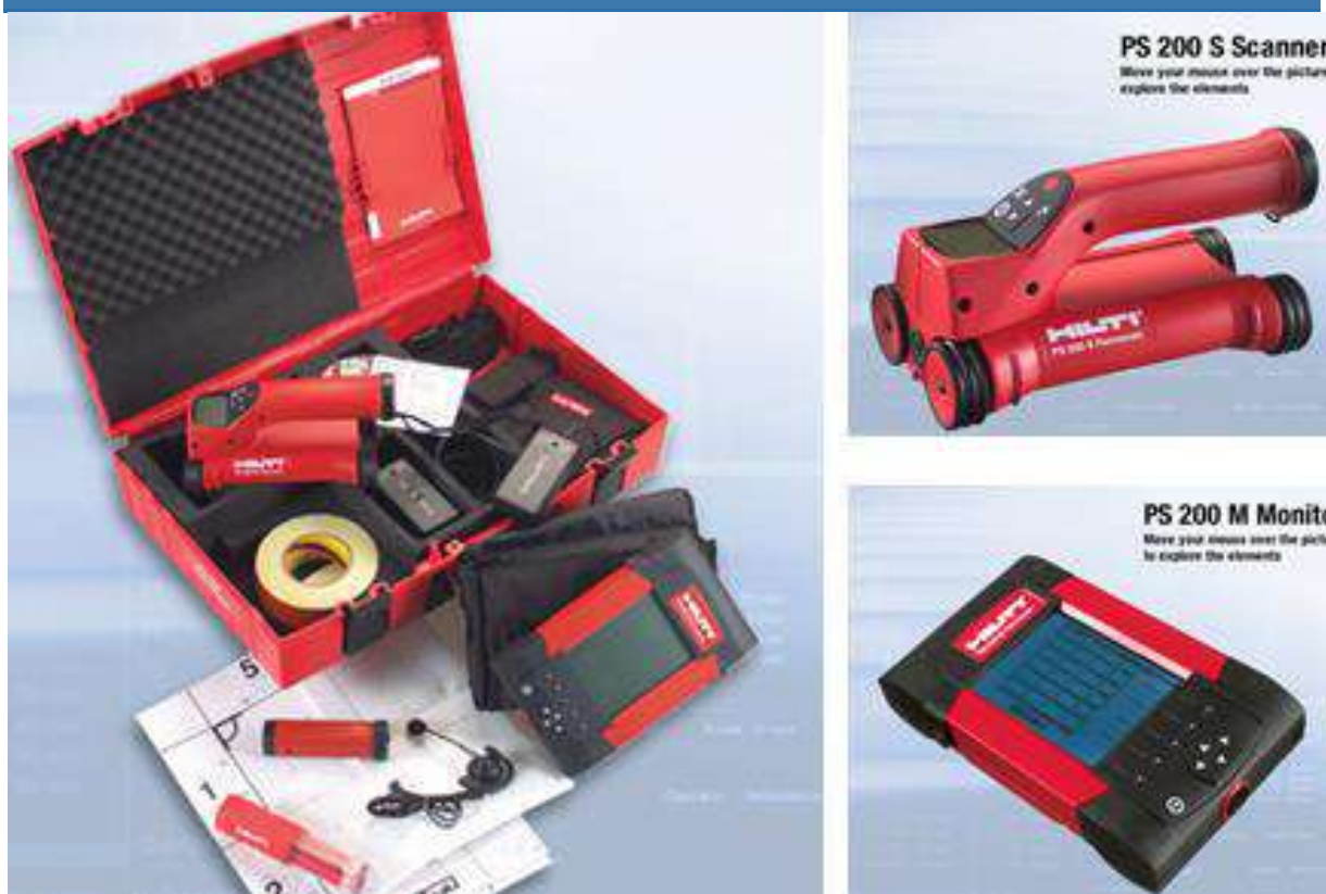
รูปที่ 3-6 ตัวอย่างเครื่องมือ Ferro Scan, HILTI PS200
