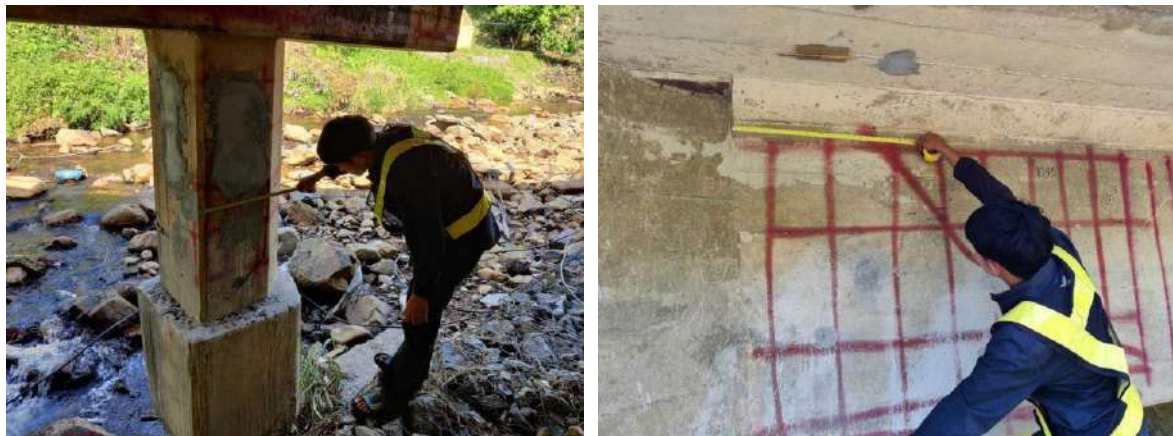
รูปที่ 4-2 การตรวจวัดมิติของสะพาน (ทั่วไป)
