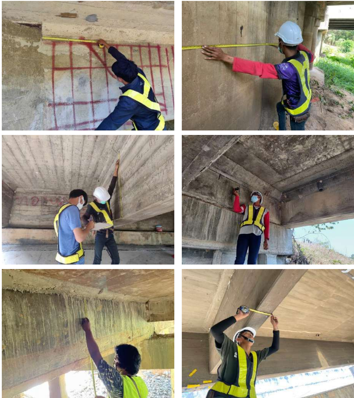
รูปที่ 3-1 ตัวอย่างการตรวจวัดมิติของสะพาน (ทั่วไป)
