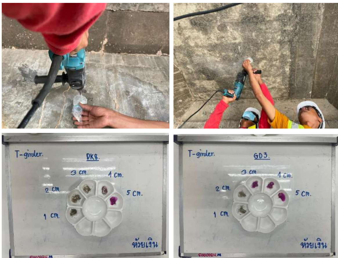
รูปที่ 6-12 รูปการทำงานทดสอบการเกิดคาร์บอนเนชั่น
