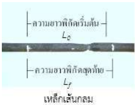
รูปที่ 3-23 ตัวอย่างการเปลี่ยนแปลงความยาวของเหล็กเส้นทดสอบ
