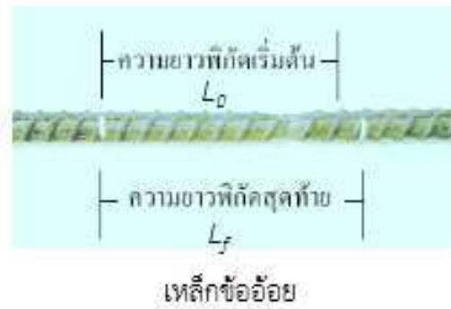
รูปที่ 3-23 ตัวอย่างการเปลี่ยนแปลงความยาวของเหล็กเส้นทดสอบ
