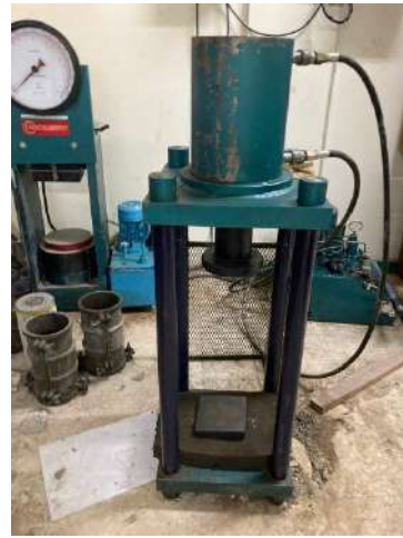
รูปที่ 3-16 ตัวอย่างการทดสอบกำลังรับแรงอัดของแท่งคอนกรีตแบบทำลาย
