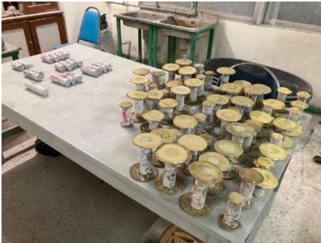
รูปที่ 3-16 ตัวอย่างการทดสอบกำลังรับแรงอัดของแท่งคอนกรีตแบบทำลาย
