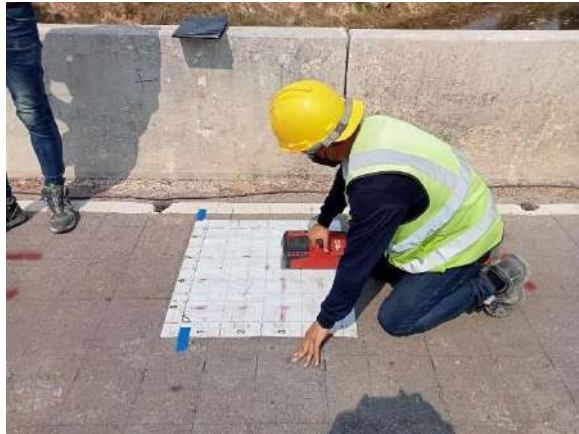
รูปที่ 6-6 รูปการสำรวจรายละเอียดเหล็กเสริมโครงสร้างสะพานด้วยเครื่อง GPR
