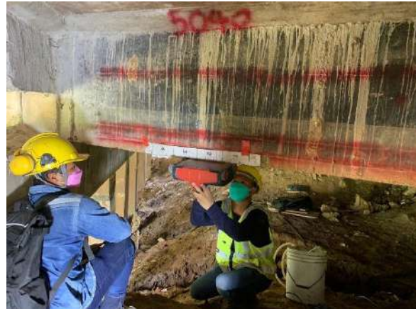
รูปที่ 5-6 รูปการสำรวจรายละเอียดเหล็กเสริมโครงสร้างสะพานด้วยเครื่อง GPR
