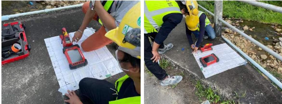
รูปที่ 4-6 รูปการสำรวจรายละเอียดเหล็กเสริมโครงสร้างสะพานด้วยเครื่อง GPR
