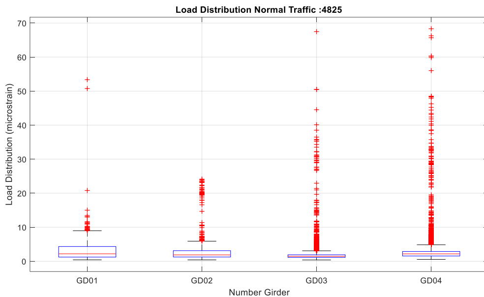
รูปที่ 4-24 การกระจายน้ำหนักในโครงสร้างคาน
