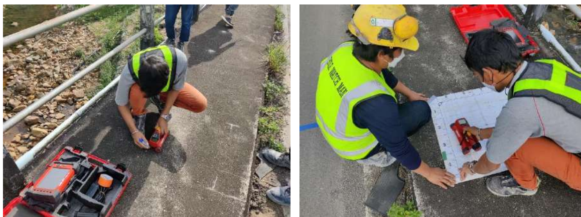
รูปที่ 3-7 ตัวอย่างการสแกนโครงสร้างด้วยเครื่องมือ Ferro Scan
