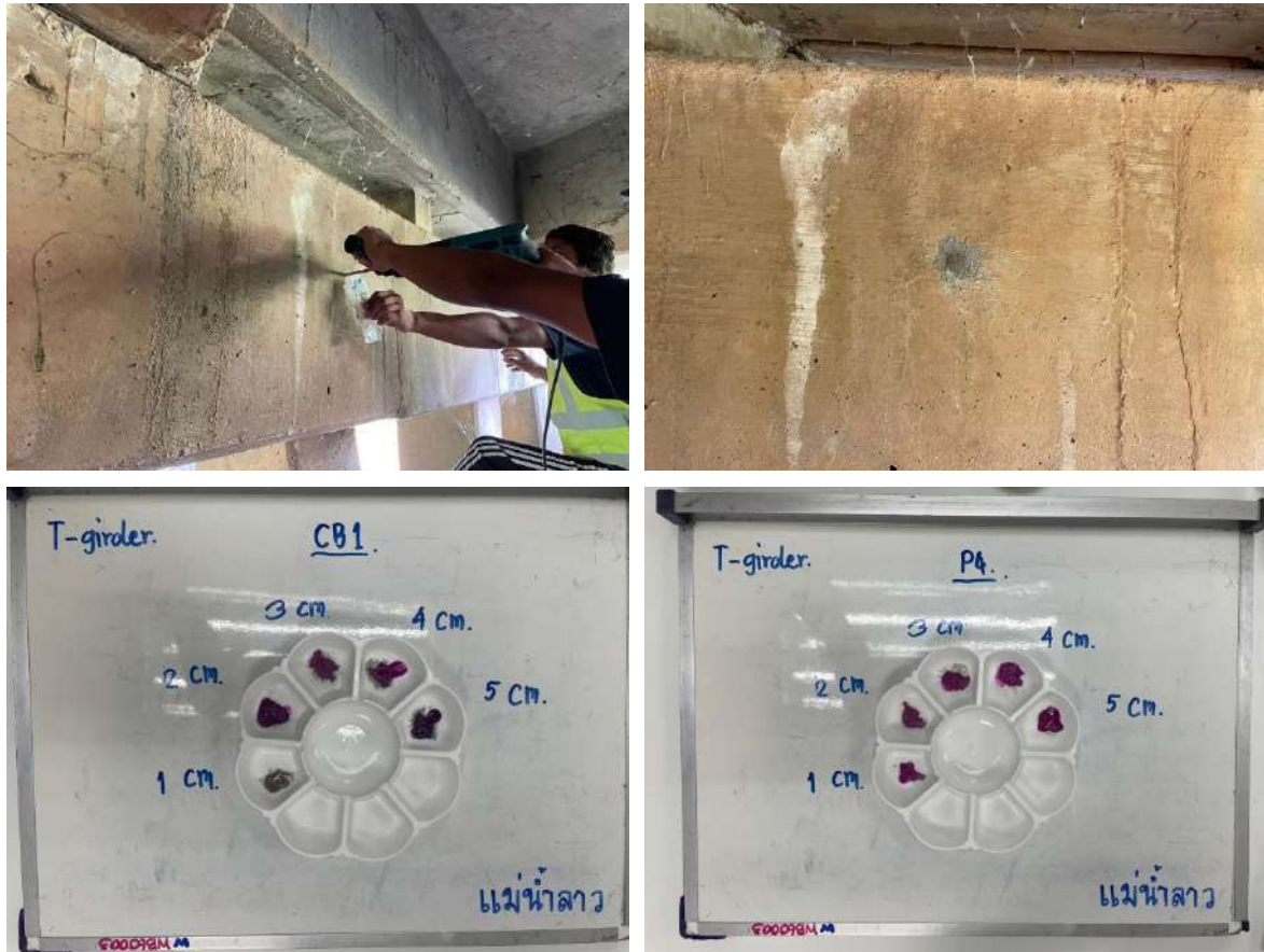
รูปที่ 5-12 รูปการทำงานทดสอบการเกิดคาร์บอนเนชัน
