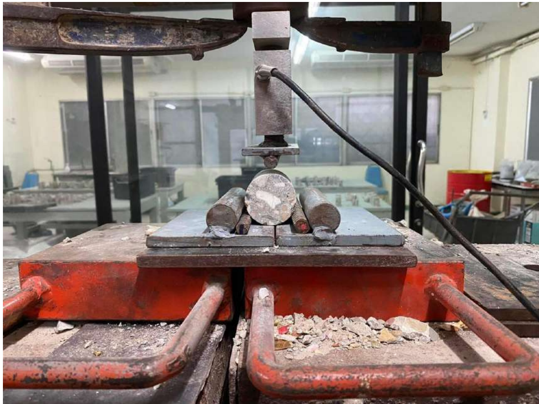
รูปที่ 3-18 การทดสอบแรงดึงโดยวิธีการผ่าซีก (Splitting tensile test)
