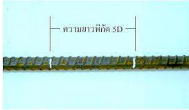
รูปที่ 3-21 การกำหนดความยาวพิกัด (Gauge Length)
