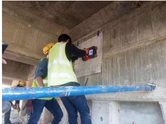
รูปที่ 6-6 รูปการสำรวจรายละเอียดเหล็กเสริมโครงสร้างสะพานด้วยเครื่อง GPR
